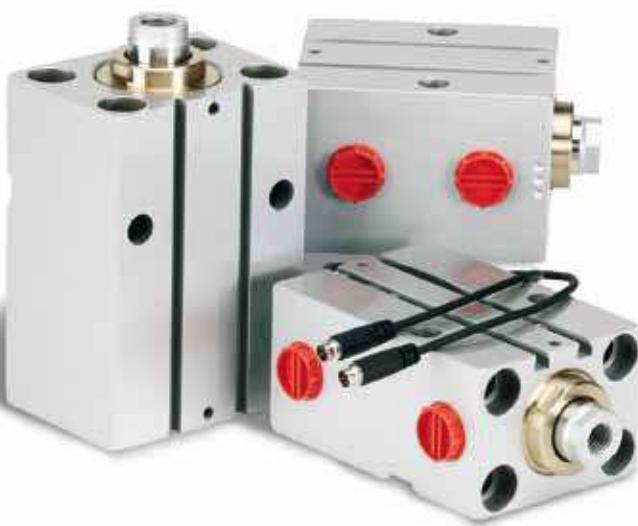
Cilindri idraulici a doppio effetto in alluminio ad alta resistenza con trattamento anti-usura. Adatti per applicazioni di automazione industriale in condizioni non gravose, quando è necessaria una costruzione leggera, compatta e ad alta modularità. Progettati anche per l'impiego con sensori magnetici incorporati per il controllo della posizione del pistone.
